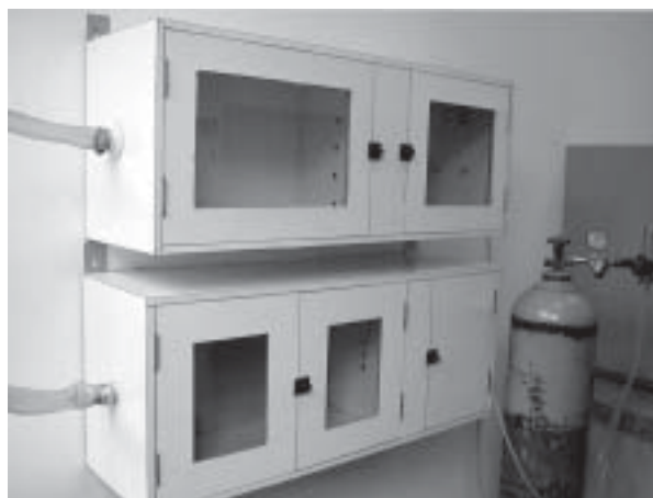
Figura 1- Sistemas utilizados para exposição dos animais ao ar comprimido (sistema inferior) e a fumaça do tabaco (sistema superior), constando de cilindro de ar comprimido, compartimento de combustão, parede fenestrada, compartimento de inalação e via de exaustão.
