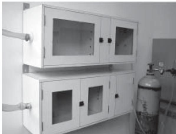
**Figura 1-** Sistemas utilizados para exposição dos animais ao ar comprimido (sistema inferior) e a fumaça do tabaco (sistema superior), constando de cilindro de ar comprimido, compartimento de combustão, parede fenestrada, compartimento de inalação e via de exaustão.
