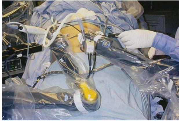
Figura 1. "Zeus", primeiro sistema robótico com braços telemanipulados clinicamente (Foto cortesia UPMC – Universidade de Pittsburgh)
