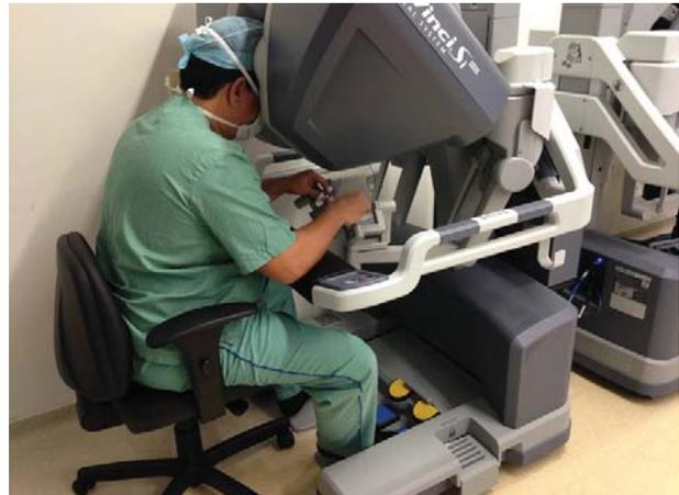
Figura 2. Evolução do sistema robótico "Da Vinci": a sua versão mais recente possui duplo console para treinamento e simulação realística.
