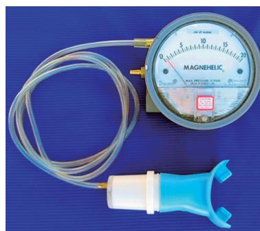
Figura 1 - Medidor de pressão mecânica
